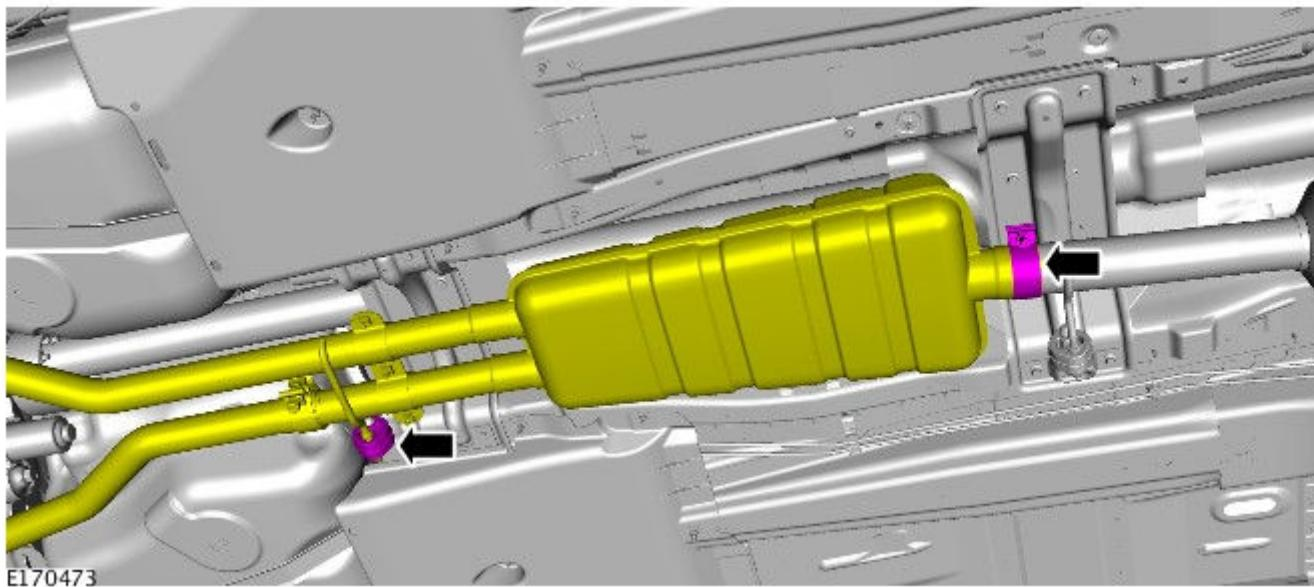
7. 小心：请确保使用合适的固定带支承排气系统。
